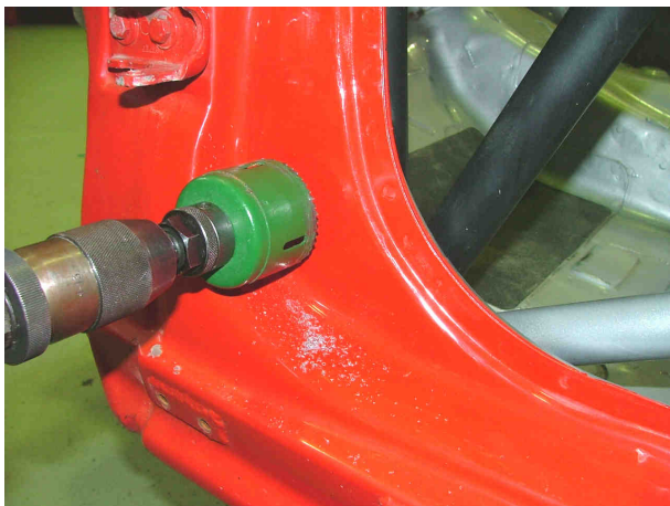
Découpage de la première tôle du côté de caisse
